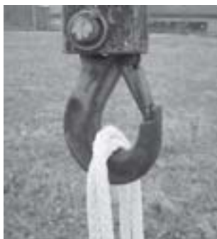
Zvedací lano zavěsit na hák jeřábu
